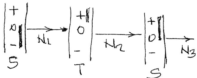
Üç aparat düz bir doğrular boyunca sıralanmıştır, fakat T aparatı bu doğrular etrafında ~~90°~~ dönderilmiştir. S aparatlarının göre  $90^\circ$  dönderilmiştir. Spin  $\downarrow$  parçacıklardan oluşan bir demet soldan deney eetine giriyor. Birinci S aparatını geçen parçacık demeti saniyede  $N_1$  parçacık ~~girdi~~ siddetine sahiptir.
