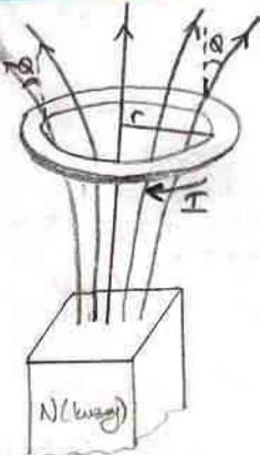
Sabitdeki gibi, I akımı taşıyan r yarıçaplı yarışır bir silindirin altına konulmuş bir manyetik alan yerleştiriliyor. Manyetik kuvvet çizgileri silindrin bulunduğu yerde düzleme Q ekseni yarışır, silindirin altına konulmuş bir manyetik alanın bu düzleme paralel olduğunu göster.
