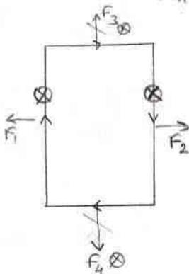
Burada  $I_1$  akımı geçen tel iltelde manyetik alan oluşturur. İlmeğin alt ve üst tellelerinde oluşan kuvvetler birbirini yok eder.
