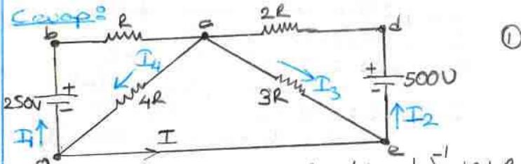
$$4\Omega \text{ və } 3\Omega \text{ paraleldir. } R_p = \left(\frac{1}{4\Omega} + \frac{1}{3\Omega}\right)^{-1} = 1.71 \Omega$$
