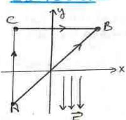
Şekilde düzgün elektrik alan negatif y ekseninde doğrudır ve  $325 \text{ V/m}$  şiddatındadır. A noktasının koordinatları  $(-0,2; -0,3)$  m ve B noktasının koordinatları  $(0,4; 0,5)$  mdir. A C B yolunu kullanarak  $V_B - V_A$  potansiyel farkını bulunuz.
