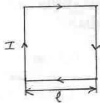
Konar uzunluğu  $l=0,4\text{m}$  olan kare biçimli bir iletken içindeki akım  $I=10\text{A}$  olduğunda, konarın merkezinde oluşan manyetik alanın büyüklüğüne ve yönü bulunuz.
