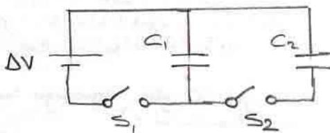
Şevideki devrede  $C_1 = 6\mu\text{F}$ ,  $C_2 = 3\mu\text{F}$  ve  $\Delta V = 20\text{V}$ dur.  $S_1$  anahtarı kapattıktan sonra  $C_1$  kondansatörü yüklüyor, sonra  $S_1$  anahtarı açılır ve yüklenmiş kondansatör,  $S_2$  anahtarı kapattıktan sonra  $C_2$  kondansatörün baslangıçta kozondığı yükü ve kondansatörlerin her birindeki son yükü hesaplayınız.
