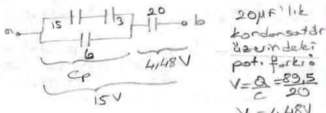
✓ Seri bağlamada  $V = V_1 + V_2$  dir,
